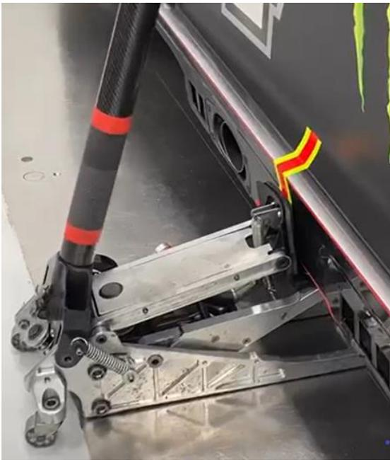
Imagen N°1- Crique Hidraulico
