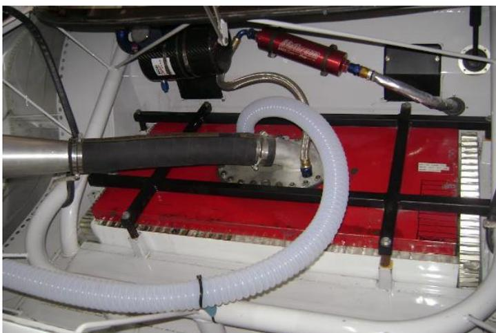
La manguera de venteo deberá salir perpendicular al tanque de combustible y el giro de la misma deberá hacerse lo más próximo a la tapa de baúl a fin que evitar derrames de combustible con tanque lleno.
