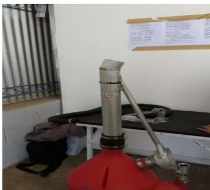
6. **MANGUERA FLEXIBLE DE VENTEO:** deberá ser apta para hidrocarburos. Sera de 1 ½” de diámetro comercial con un espesor de 5 mm y un largo máximo de 1650 mm. Deberá apretarse con una abrazadera 32-50 en el caño de venteo de la mamadera.
